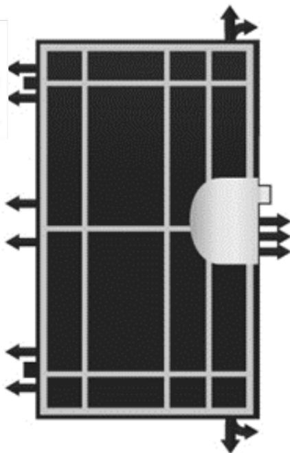
Sicherheitstürblatt mit Stahlverstrebungen und 2 durchgehenden Stahlplatten im Türblattinneren sowie 11-fach Tresorbolzen-Verriegelung
